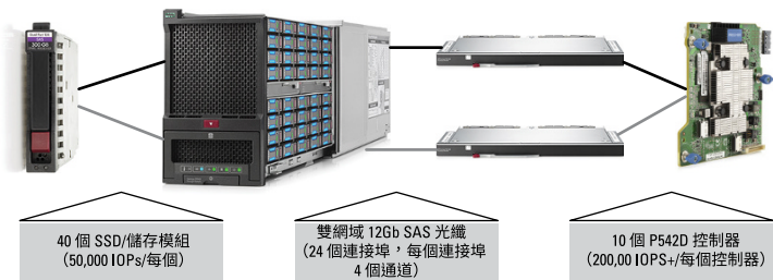
圖 7-2：HPE Synergy 儲存模組非封鎖光纖架構。
